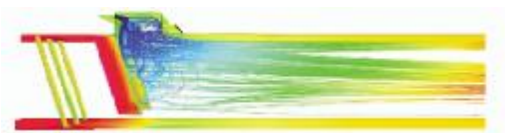
图 26 驻涡加力燃烧室流线
