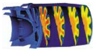
图 19 M88-2 发动机加力燃烧室冷态温度分布
