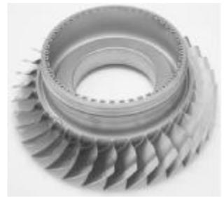
图 23 LEAP-X 高压压气机转叶外形
